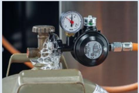
Blasenbildung: Anlage undicht!
