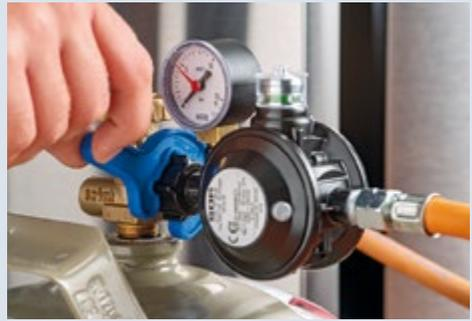
Montage eines Druckreglers mit dem [GOK-MiniTool](#)
