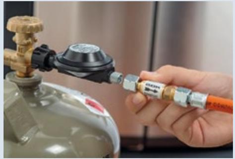
Anschluss einer Schlauchbruchsicherung an den Druckregler
