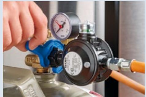
Montage eines Druckreglers mit dem [GOK-MiniTool](#)
